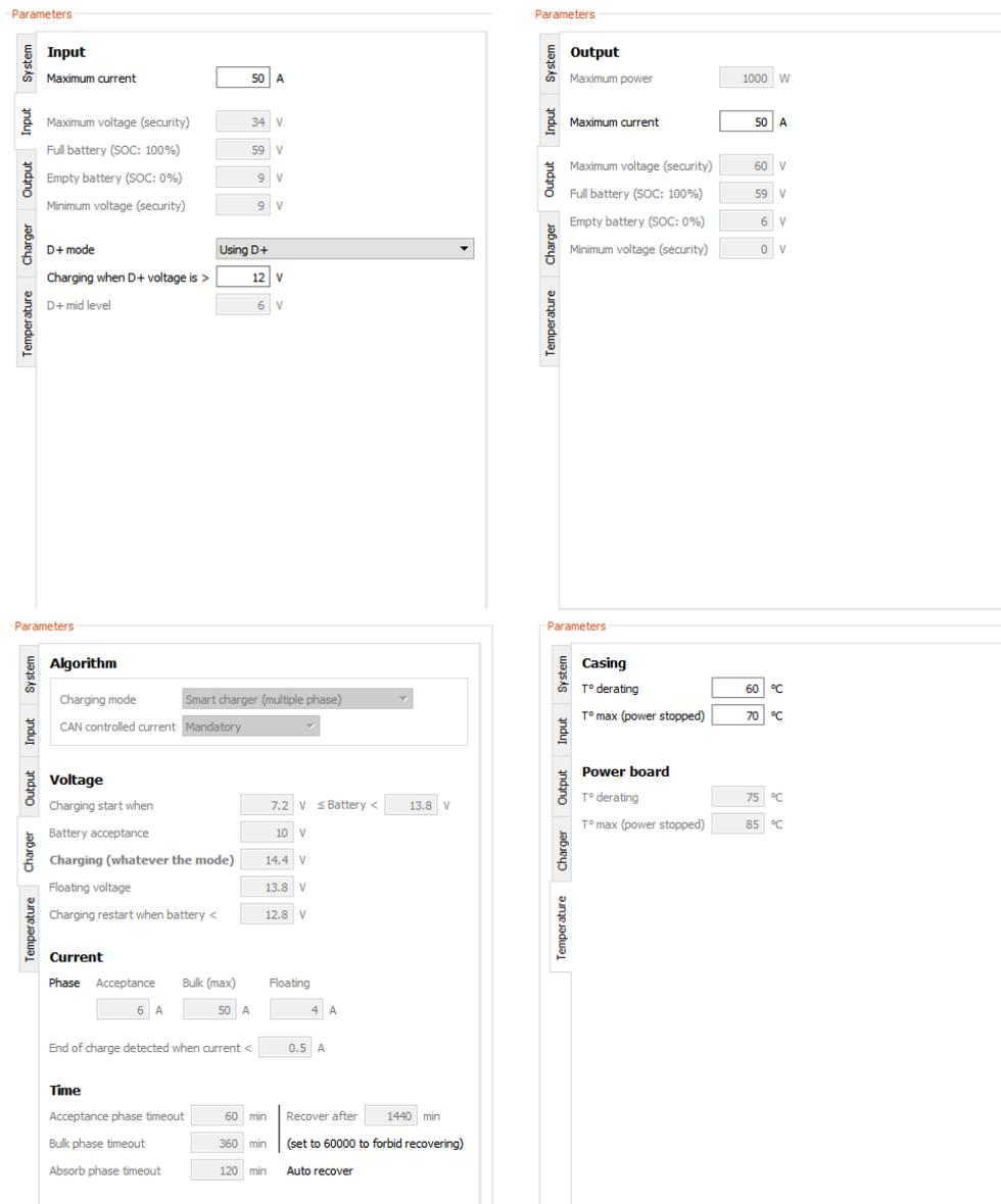
Figure 11 : Supervisor's « Details » panel in Silver mode, « Parameters » tab, different subtabs
